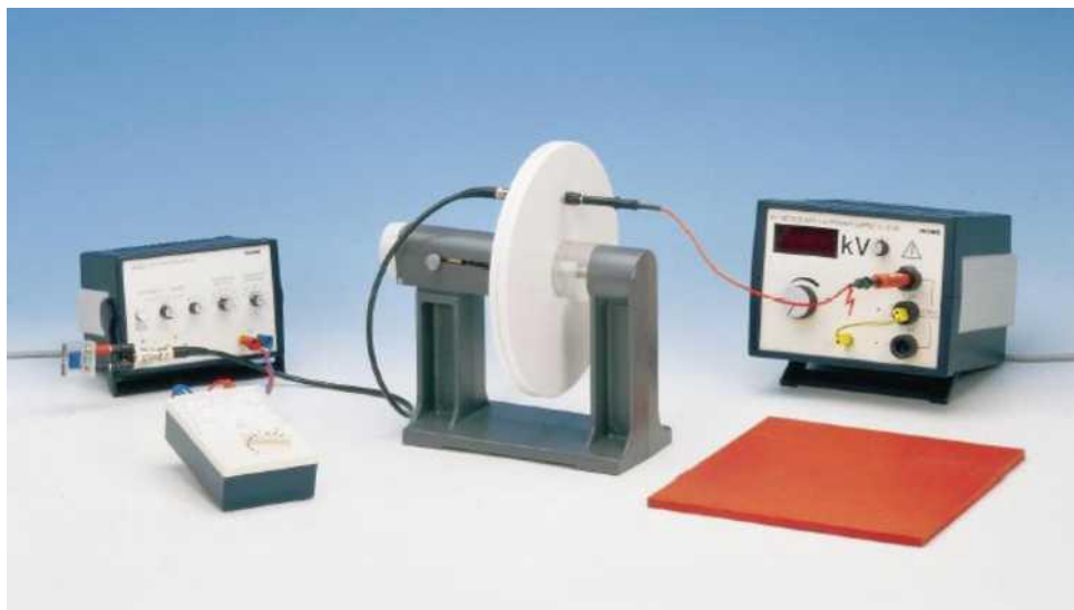
Gambar 7. Set up alat percobaan konstanta dielektrik bahan
